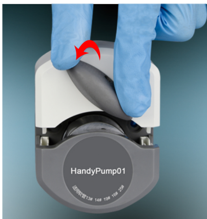
1. 逆时针扳动旋钮 180°, 打开压块。
